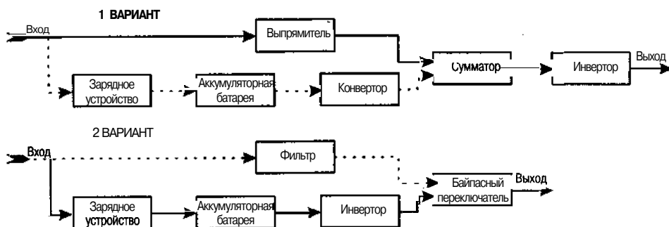
Рис. 2.36. Структурная схема UPS типа on-line
